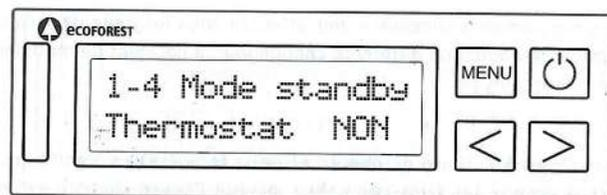
En sélectionnant OUI à l'aide de la touche l'appareil se coupera lorsque la température sera atteinte et se remettra en marche ensuite. (Pour utiliser le mode « stand by », le mode « Thermostat » doit être également actif).
