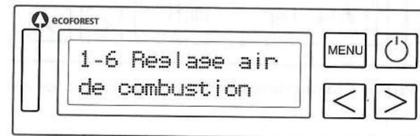
Bien que l'appareil se règle automatiquement, dans certaines configurations il peut être possible de réaliser un réglage plus précis. Dans tous les cas, ne modifiez pas ces paramètres sans l'accord de votre installateur.
