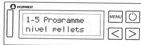
Ce MENU permet de déterminer le niveau de puissance que l'appareil atteindra automatiquement suite à la phase d'allumage, et en programmation. Par défaut, il est réglé à niveau 5. Vous pouvez augmenter cette valeur à l'aide de la touche et la réduire à l'aide de la touche .
