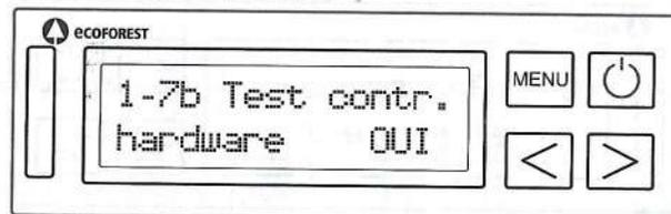
Il vous permet d'activer ou désactiver le test électronique que l'appareil réalise avant chaque allumage. ne modifiez pas ces paramètres sans l'accord de votre installateur.
