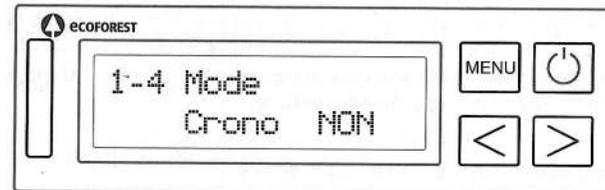
En sélectionnant OUI à l'aide de la touche > l'appareil s'allumera et s'éteindra aux différentes plages horaires programmées (sans prendre en compte la température « off »). En sélectionnant NON, à l'aide de la touche <, l'appareil ne s'allumera pas automatiquement.
