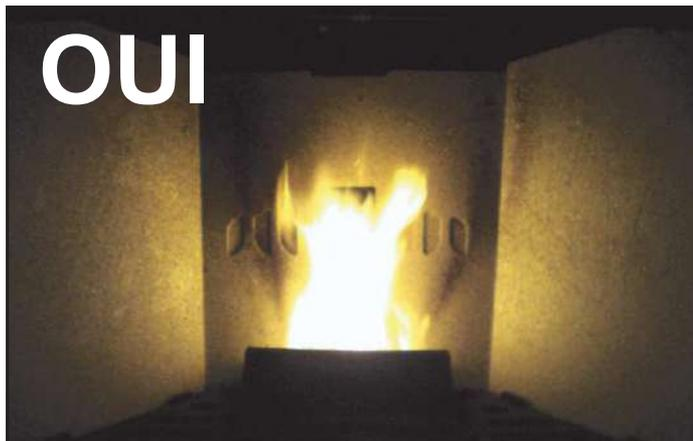
Combustion **OPTIMAL**, la flamme est vivante avec une couleur jaune / blanc avec une petite quantité de pellet dans le brasero. Il n'est pas nécessaire de modifier une valeur dans le menu **TARATURE**.
